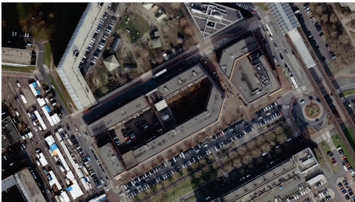
Figuur 1.1: Satellietbeeld waar de ventweg van de Bijlmerdreef door parkeerbewegingen vastloopt. Te zien is dat dit effect heeft op het verkeer op de rotonde (Google maps)
